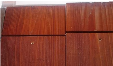
写真12 着色タイプの試験体 N09 上：塗装時/下：暴露後・左から含水率①② 暴露前後でもほとんど差は見られない
