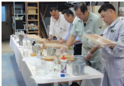
写真5 試験体のスギ板に塗装
