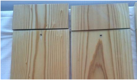
写真10 クリアタイプの試験体 N01 上：塗装時/下：暴露後・左から含水率①② 暴露前後でほとんど変化なし
