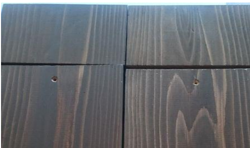
写真13 着色タイプの試験体 N012 上：塗装時/下：暴露後・左から含水率①② 含水率②のほうは色が薄めの仕上がり
