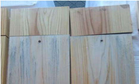
写真11 クリアタイプの試験体 N04 上：塗装時/下：暴露後・左から含水率①② 暴露前後で退色が顕著に見られる。 塗膜が劣化している。
