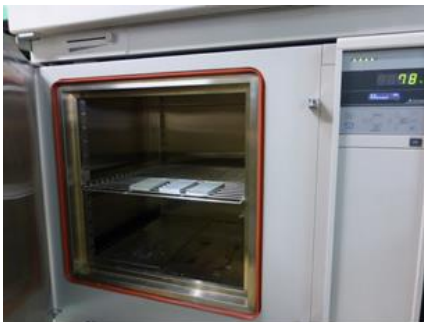
写真5 循環式恒温機 (試験体を設置)
