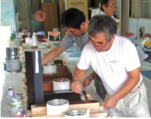
写真 試験体の作製 杉の角材に各種塗装
