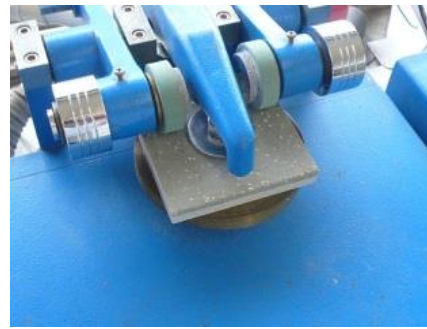
写真-5 テーパー摩耗試験風景
