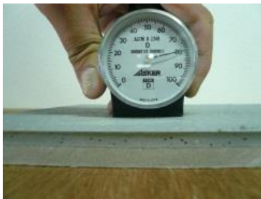
写真3 塗膜硬度測定
