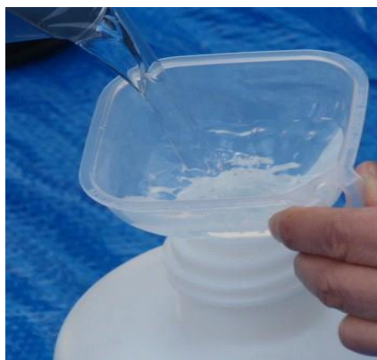
写真 4 濾過後、凝集物を除去した処理水を採取
