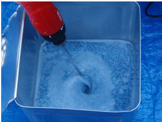
写真 1 水性アクリルエマルジョン塗料 2%水溶液に凝集剤を投入攪拌
